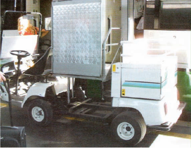
Fotoğraf 15: Trenitalia'nın özürlü yolcular için geliştirdiği tekerlekli sandalye lifti.
