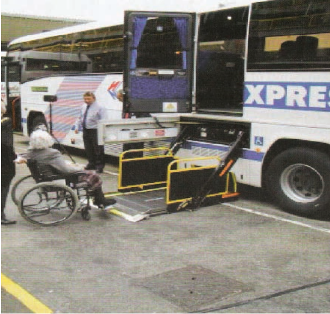
Fotoğraf 20: Taşıta monte edilen liftler aracılığıyla yüksek tabanlı bir yolcu otobüsüne erişim mümkündür.
